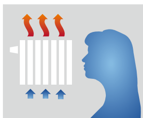
Ineffiziente Wärmeverteilung bei Einsatz einer Konvektionsheizung
